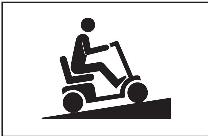
Figura 4. Posición de conducción de mayor estabilidad
