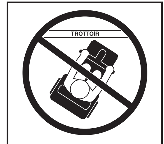
Figure 7. Approche incorrecte de trottoir
